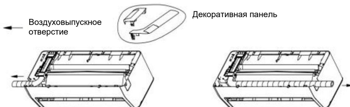
Шаг 1. Оберните защитную ленту из ПВХ вокруг дренажной трубы, медной трубы и кабеля. Придайте медной трубе подходящую форму.
